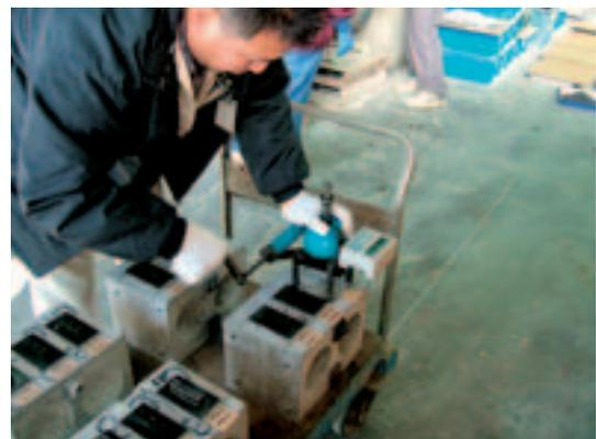
写真8 付着強度試験状況
