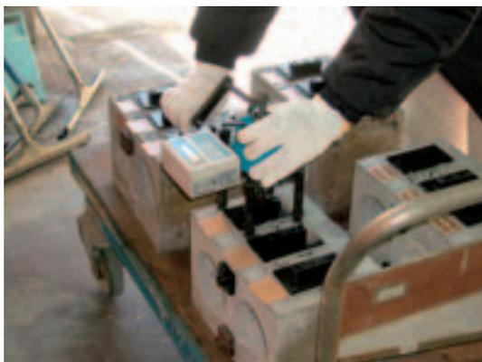
写真7 付着強度試験状況
